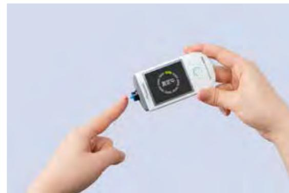
移動式遠心方式臨床化学分析装置
